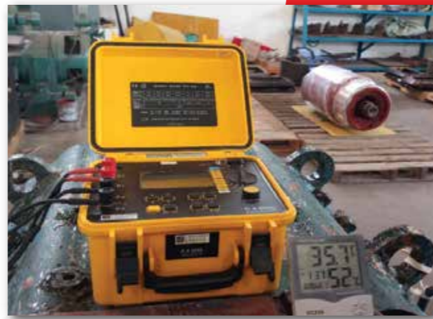
Thiết bị đo điện trở nhỏ - Chauvin, Pháp CA 4240 Micro-Ohmmeter- Chauvin, France
