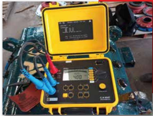
Thiết bị đo thông số chất lượng bộ dây động cơ - Chauvin, Pháp The CA 6547 megohmmeter for quantitative and qualitative analysis of Winding insulation
