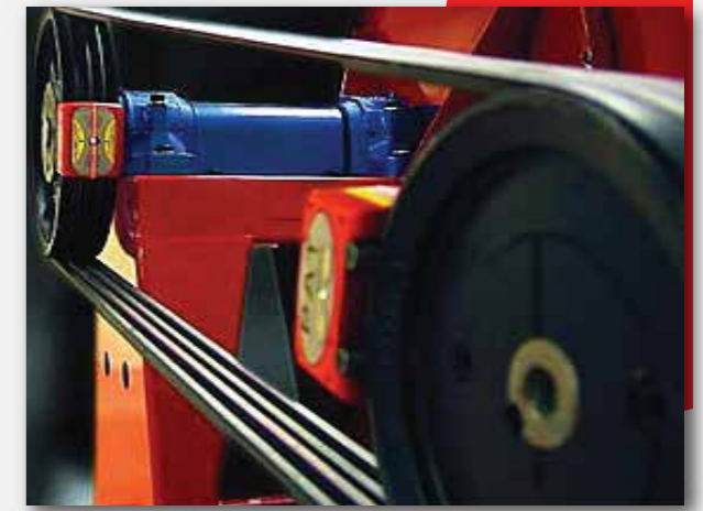
Thiết bị căn chỉnh đồng tâm Puly bằng laser Laser pulley concentric alignment device
