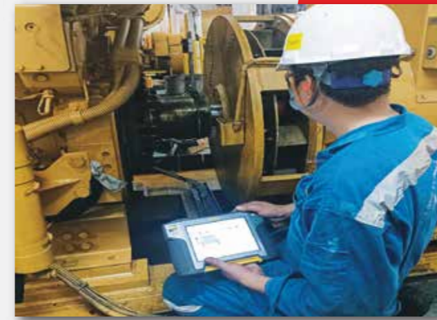
Thiết bị căn chỉnh đồng tâm trục bằng laser Laser axial concentric alignment device
