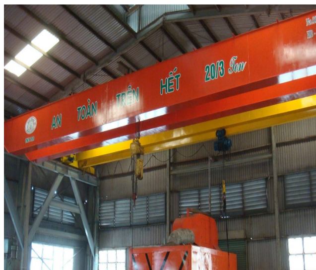
Hệ thống cầu trục tải trọng nâng đến 40T Crane system with lifting capacity up to 40 tons
