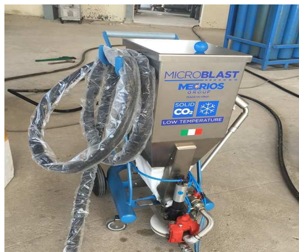
Thiết bị làm sạch bề mặt bằng đá CO2 không tổn hại bề mặt/ The equipment for cleaning by CO 2 stone without damage of the surface.
