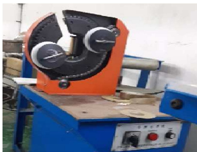
Thiết bị băng cách điện bin dây Stato động cơ trung thế / The machine make the stator of medium motor winding insulation lap.
