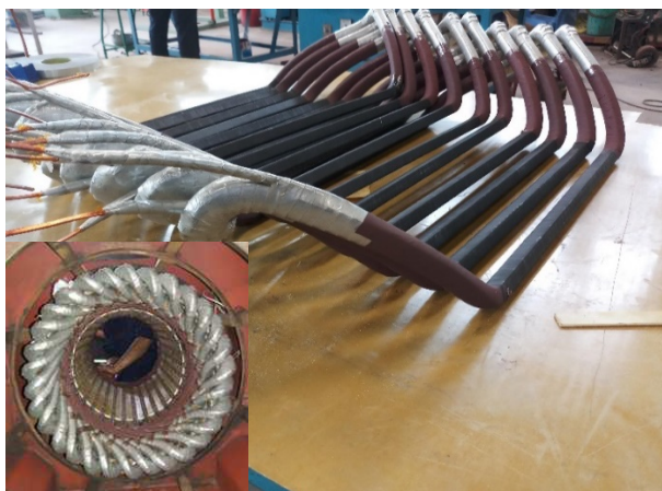
Thay mới bộ dây Stato động cơ trung thế 450kW-6,6kV-3000rpm/ Replace the winding for the stator motor 450kW-6.6kV-3000rpm
