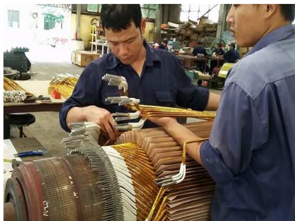
Thay mới bộ dây Roto động cơ một chiều 250kW/ Replace the rotor winding of the DC motor 250kW
