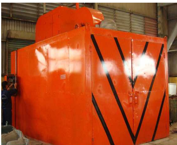
Lò sấy lớn, khả năng sấy Stato động cơ và máy phát đến 15MW / Large drying Oven: Drying Stato of Motor and Generator up to 15MW
