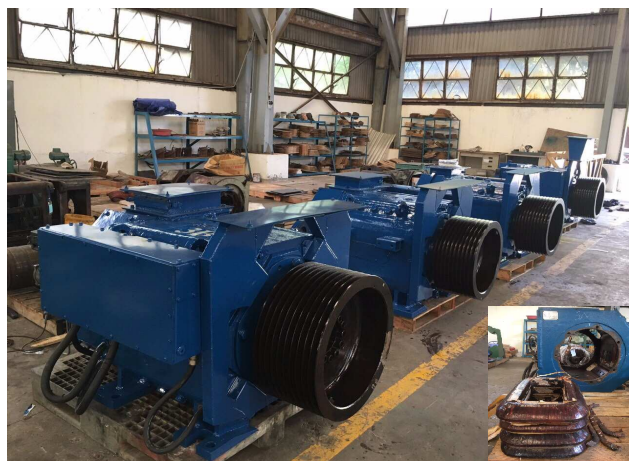
Thay mới bộ dây kích từ động cơ một chiều GE752 DC1000HP giàn khoan dầu khí/ Replace the field coil of the motor DC 1000HP on the rig
