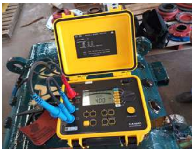
Thiết bị đo thông số chất lượng bộ dây động cơ – Chauvin Pháp / The Equipment to test the quality parameters of motor – Chauvin France
