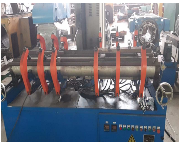
Thiết bị chế tạo bin dây động cơ trung thế / The machine make the stator coil of the medium voltage Motor
