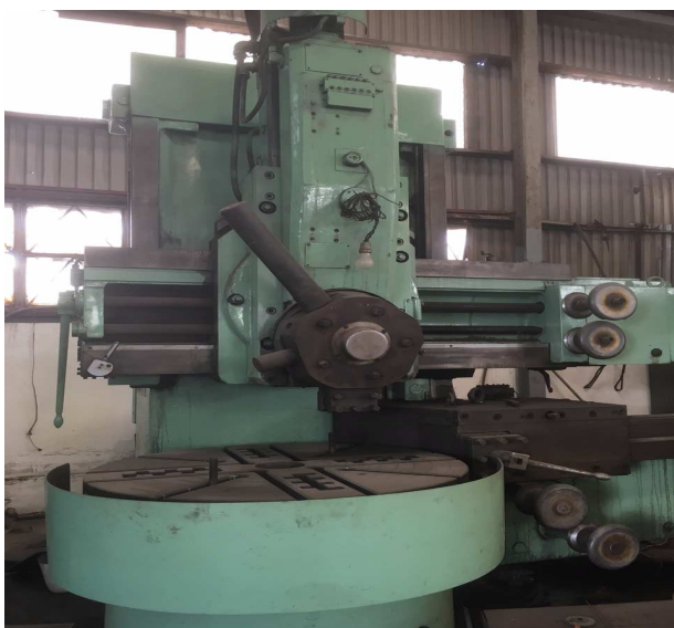
Máy tiện đứng khả năng gia công đến đường kính 2m/ The vertical Lathe can be machined up to 2 meters in Diameter
