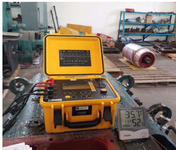
Thiết bị đo điện trở nhỏ Chauvin – Pháp/ The equipment to test the resistor of winding motor. Chauvin - France
