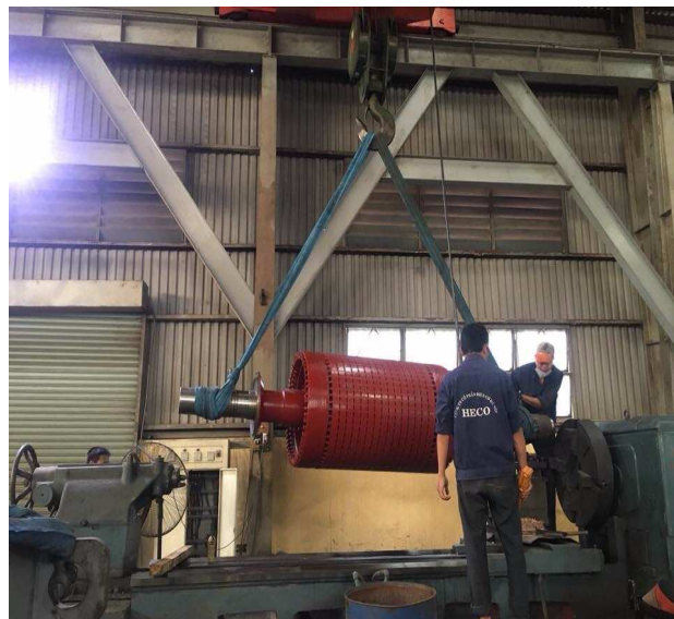
Máy tiện ngang có thể gia công vật nặng đến 3,6 tấn/ The horizontal lathe can be machined up to 3,6 tons
