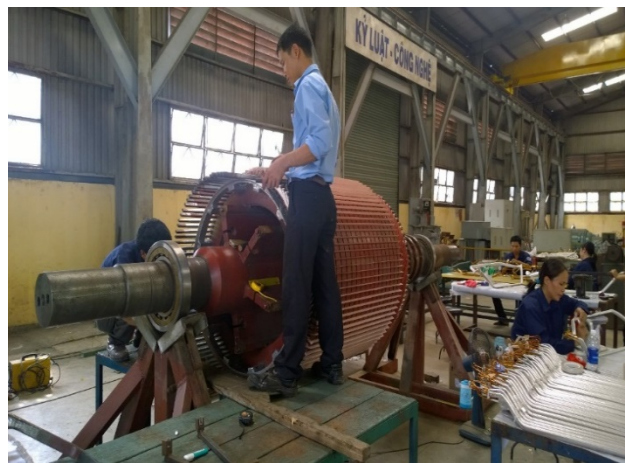
Sửa chữa thay mới bộ dây Roto động cơ 3550kW – 6,6kV/ Replace the rotor coil of the motor 3550kW – 6.6kV
