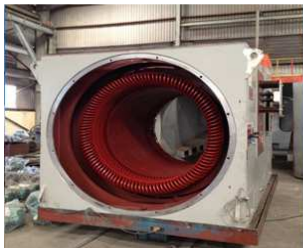
Bảo dưỡng động cơ 7500KW-6kV cho nhà máy xi măng/ Maintenance and repair motor siemens 7500KW – 6KV – Cement Company
