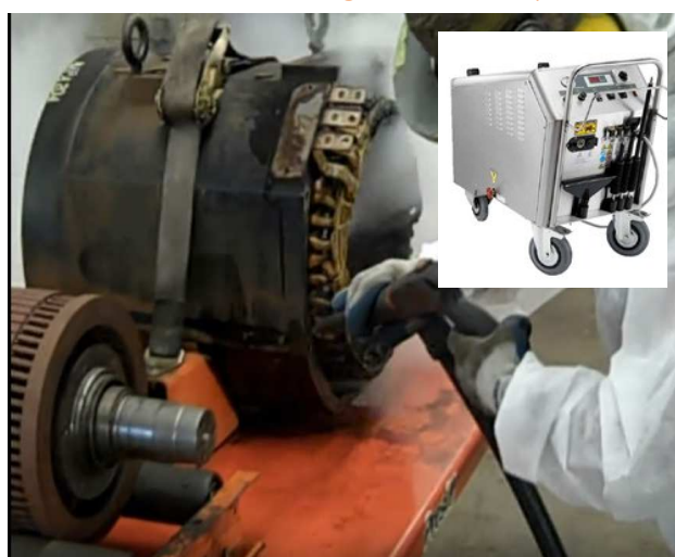
Thiết bị làm sạch bộ dây động cơ bằng hơi nước nóng/ The equipment for the cleaning of coil motor by hot steam.
